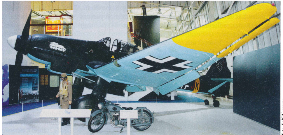
Der Stuka von Hendon ist eines von nur noch zwei Exemplaren der Junkers Ju 87 (Sturzkampfbomber, Tiefdecker mit Knickflügeln, starrem Fahrgestell und zwei Mann Besatzung), die heute weltweit im Originalzustand zu sehen sind
